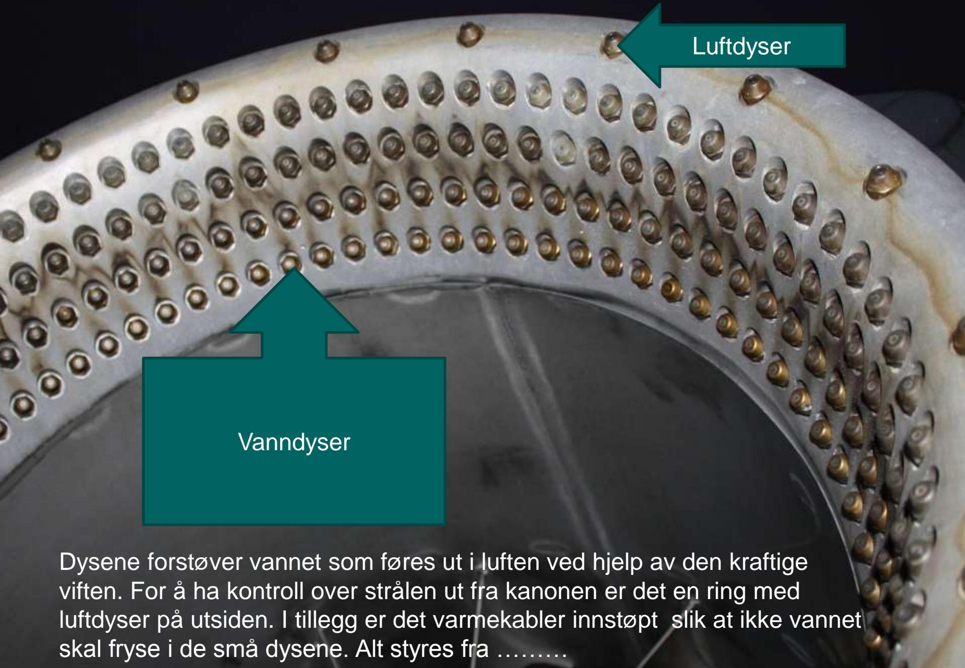
Dysene forstøver vannet som føres ut i luften ved hjelp av den kraftige viften. For å ha kontroll over strålen ut fra kanonen er det en ring med luftdyser på utsiden. I tillegg er det varmekabler innstøpt slik at ikke vannet skal fryse i de små dysene. Alt styres fra .....
