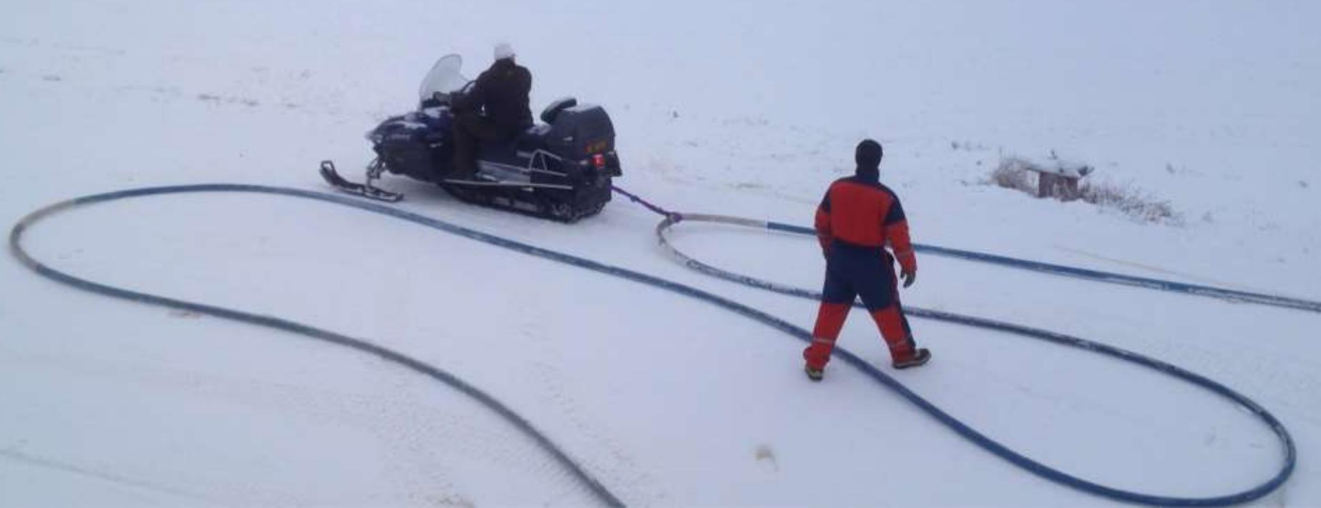
Hold alltid sugeslangen i forkant av det området der du legger snø. Trekk den frem med ATVen (Scooteren) for hver gang du kjører frem traktoren. Da unngår du at slangen fryser fast i nylagt snø. Når du er kommet så langt frem at slangen rekker til neste hydrant, er det på tide med hydrantbytte.
