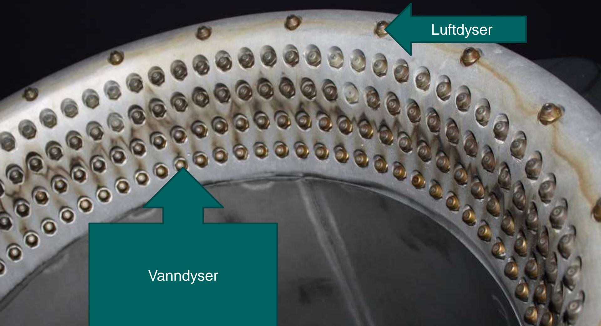
Dysene forstøver vannet som føres ut i luften ved hjelp av den kraftige viften. For å ha kontroll over strålen ut fra kanonen er det en ring med luftdyser på utsiden. I tillegg er det varmekabler innstøpt slik at ikke vannet skal fryse i de små dysene. Alt styres fra .....
