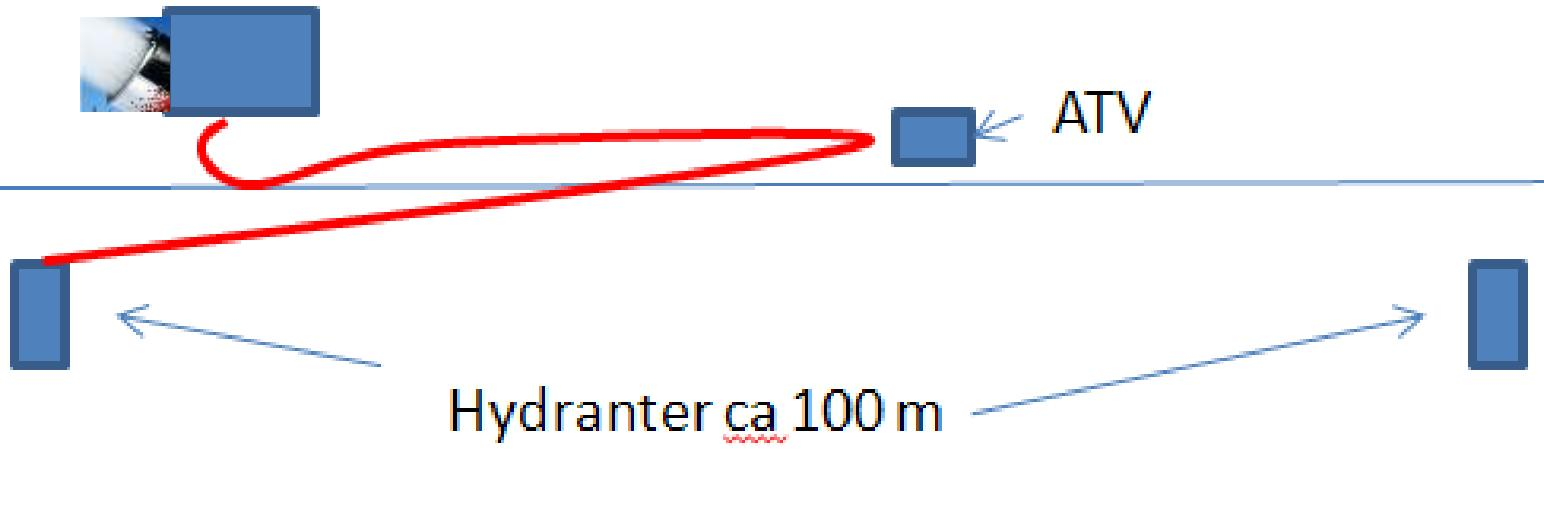
Hold alltid sugeslangen i forkant av det området der du legger snø. Trekk den frem med ATVen (Scooteren) for hver gang du kjører frem traktoren. Da unngår du at slangen fryser fast i nylagt snø. Når du er kommet så langt frem at slangen rekker til neste hydrant, er det på tide med hydrantbytte.
